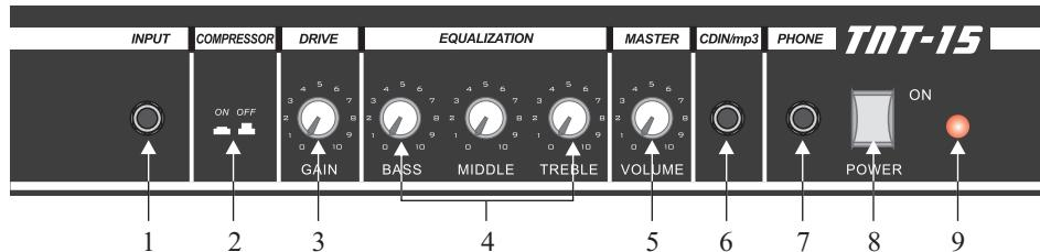
1、输入插孔(INPUT) : 用于连接吉它
